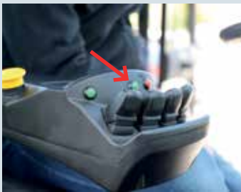
VMS activation switch on the mini lever
